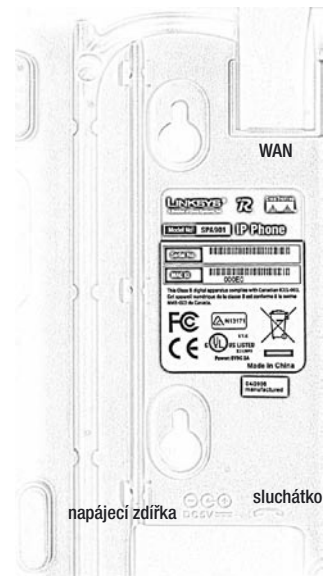
Zapojení konektorů IP telefonu
